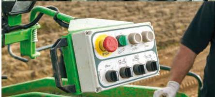
自动化功能包括：自动挖掘深度控制，自动压力控制，自动机身水平控制，料斗自动展开及卸载（两级带速），后轮自动对中功能，自动对垄功能，一级筛网自动抖土功能，刺猬筛网角度及速度自动调节。
