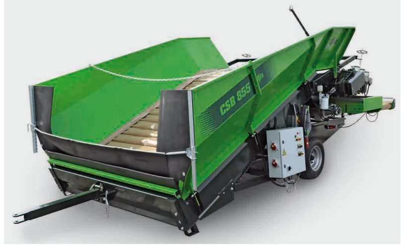
De hoek van de reinigingsunit is eenvoudig verstelbaar.
