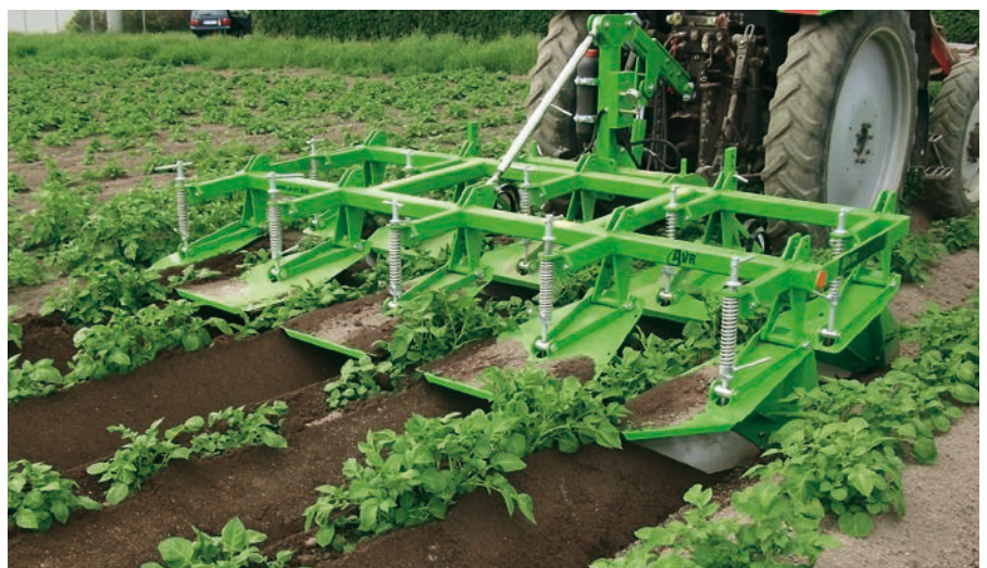
Ecoridger : importante raspado de las malas hierbas presentes en los caballones
