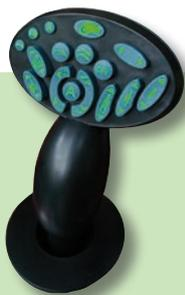
Fonctions : lever/abaisser le cadre avant, activer/désactiver les fonctions automatiques, dévers, vider la trémie (2 vitesses), roues directrices, commande du timon, abaisser/lever la trémie, vidage, inclinaison du tapis à tétines
