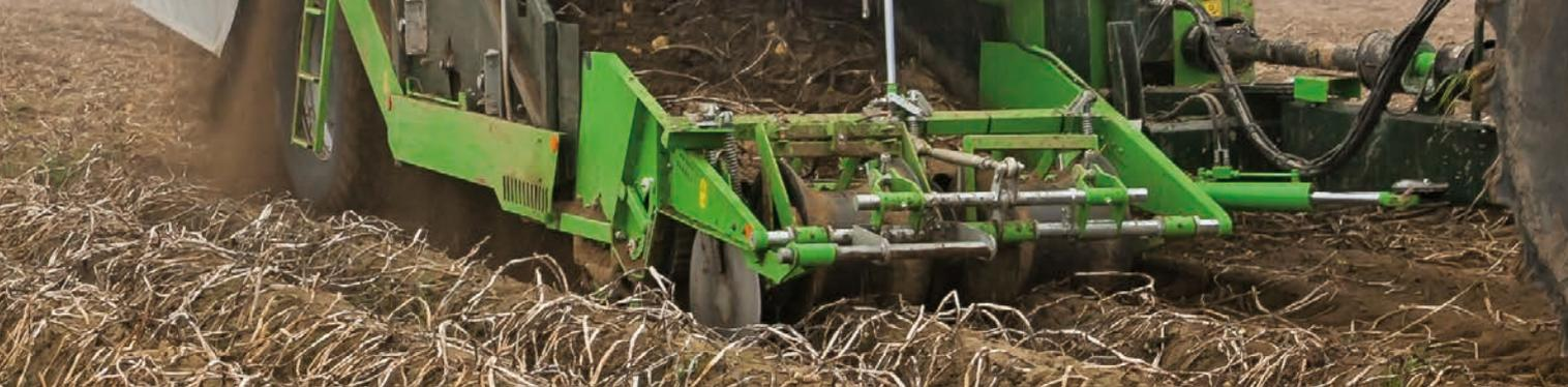
1. Tapis d'arrachage : 1 650 mm de profondeur, entraîné par des galets d'entraînement en PUR.
