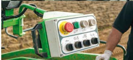
Funktionen: Aufnahme hoch/runter, automatische Funktionen an/aus, Horizontalstellung, Bunker leeren (2 Geschwindigkeiten), Lenkräder, Drehzahlsteuerung, Sternschüttler hoch/runter, Bunker hoch/runter, Leeren, Neigung des Igelbands
